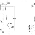
Sección Barrera Tipo F Lateral Alta (simple)
